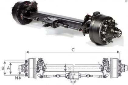
Zwangslenkachse 14200 Kg bei 40 Km/h
