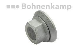
Radmutter M22 x 1.5, kurze Führung SW 32 mm, •Ø 30.5/53 mm, Höhe 27/34 mm geometisiert, für Alufelgen
